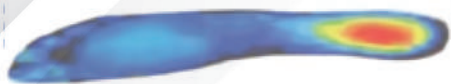
Το έγχρωμο αποτύπωμα απεικονίζει την κατανομή της πίεσης του πέλματος στο υπόδημα.
